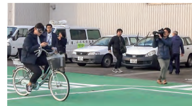
自転車スマホ中の視線運動をアイカメラを使用して計測している様子
